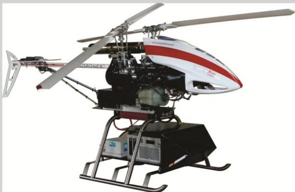
**RPAS Swiss Drones com *payload* de 35 kg e sensor LEICA RCD30 de médio formato.**
