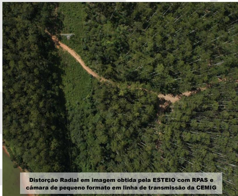
**Distorção Radial em imagem obtida pela ESTEIO com RPAS e câmara de pequeno formato em linha de transmissão da CEMIG**
